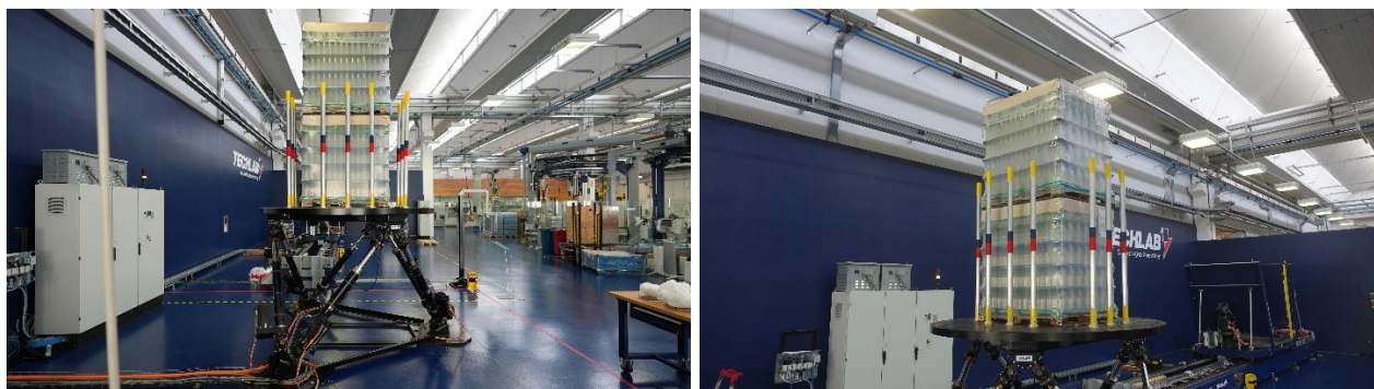
Figura 1 - Immagini pre-test di due bancali impilati verticalmente e posizionati sull'esapode.
