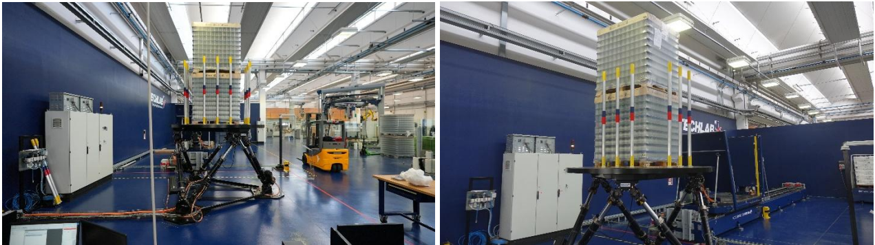
Figura 15 - Immagini pre-test di due bancali impilati verticalmente e posizionati sull'esapode.
