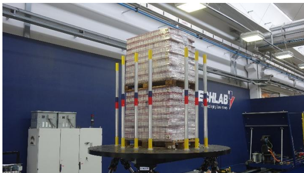
Figura 8 - Immagini pre-test di due bancali impilati verticalmente e posizionati sull'esapode.
