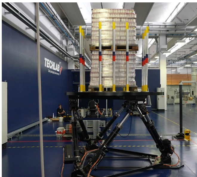
Esapode a 6 gradi di libertà durante una prova.
