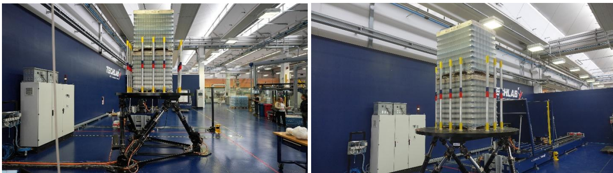
Figura 22 - Immagini pre-test di due bancali impilati verticalmente e posizionati sull'esapode.
